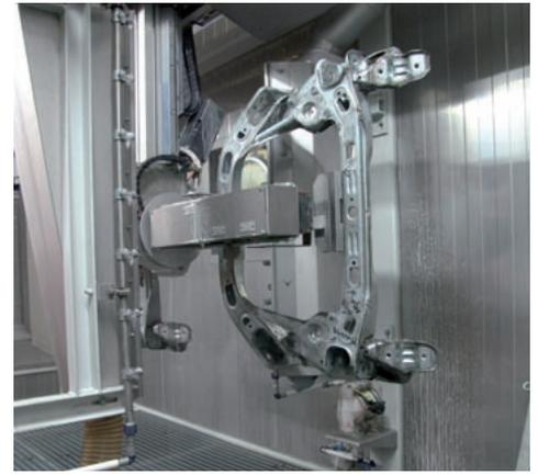
Automatische Integralträgertrocknung mit anschließender Inhibition
