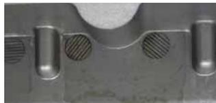
Verschmutzte und gereinigte Schlitzdüsen
