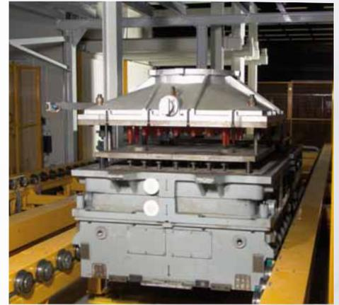
Der gereinigte und getrocknete Kernkasten auf dem Weg zurück zur Kernschussmaschine.
