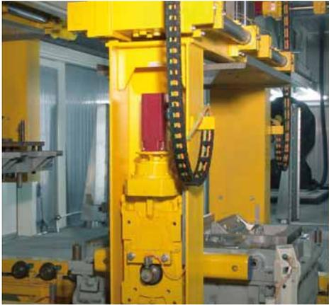
Die Manipulatoren transportieren den Unterkasten (im Vordergrund) und den Oberkasten (links) vollautomatisch zum Reinigungsplatz.
