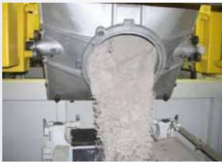
Der Manipulator dreht die Haube und der lose Sand wird ausgeschüttet
