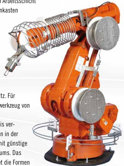
*Ein sechssachsiger Knickarmroboter gestattet eine exakte Wegprogrammierung zur optimalen Formenreinigung. Die Wasserzuführung erfolgt über eine neu entwickelte Hochdruckspiralverrohrung.*
