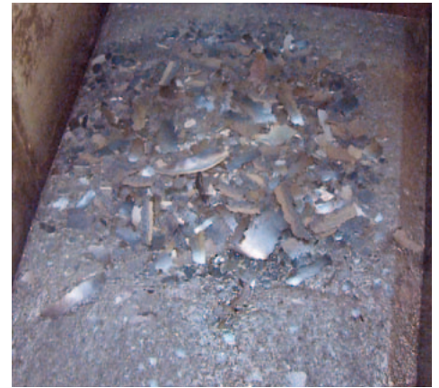
Abgestrahlte Schlackereste in der Auffangwanne der Kabine
