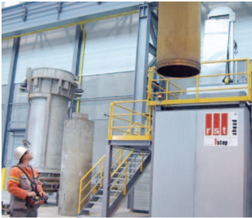
Transport des Tiegels zur RST-Reinigungsanlage
