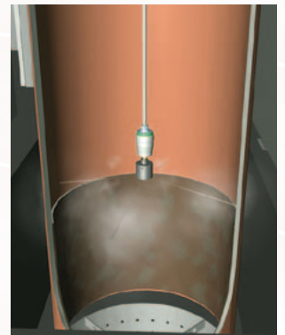
Flächendeckendes Strahlen durch Vertikalbewegung einer rotierenden, radial abstrahlenden Turbodüse
