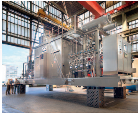
Betriebsfertig montiertes und verkabeltes Gasturbinenskid bei der Verladung
