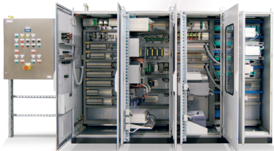
Einheitensteuerschrank (UCP) und lokales Bedienfeld (LP, Ex-Ausführung) zum Steuern und Überwachen einer Kompressoranlage. Als Prozessleitsystem kommt eine hochverfügbare, fehlersichere PCS7-Station zum Einsatz.
