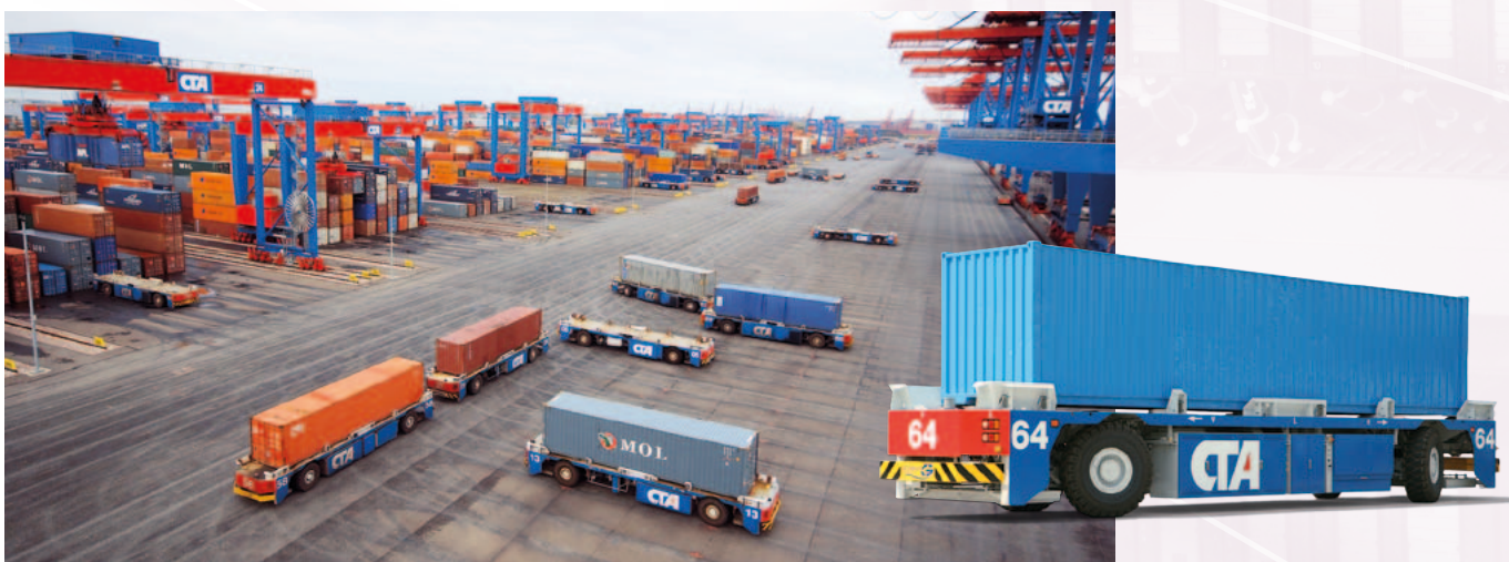
Führerlos mit Steuerungstechnik von RST unterwegs: Automated Guided Vehicles. Die ferngesteuerte Containerfahrzeuge mit diesel-hydraulischem Antrieb (AGV) oder mit diesel-elektrischem Antrieb (E-AGV) übernehmen den automatischen Transport von 20-, 40- und 45-Fuß-Containern. Ein ideales Zusammenspiel von RST-Steuerungstechnik und RST-Blechverarbeitung.
