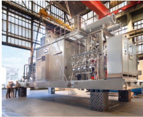
Betriebsfertig montiertes und verkabeltes Gasturbinskid bei der Verladung
