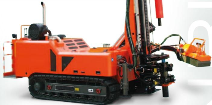
*Schallgedämmte Einhausung von Bohrgeräten*
