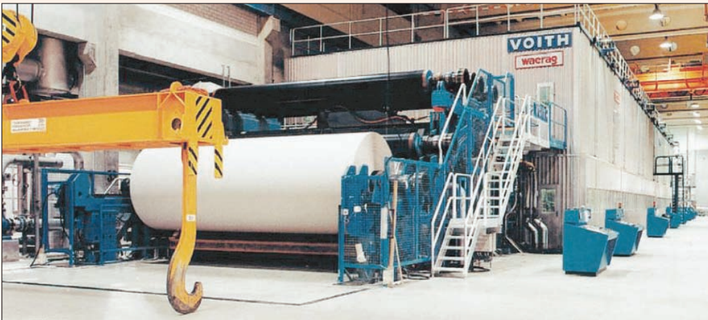
Ansicht einer 120 Meter langen Papiermaschine mit einer Durchlaufgeschwindigkeit von bis zu 1.500 Meter pro Minute.
