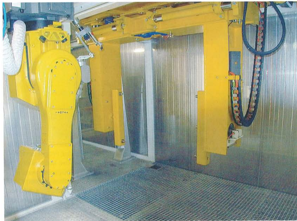
Bild 3: Robotergesteuerte Hochdruckdüsen reinigen Kernkästen schnell und schonend.
